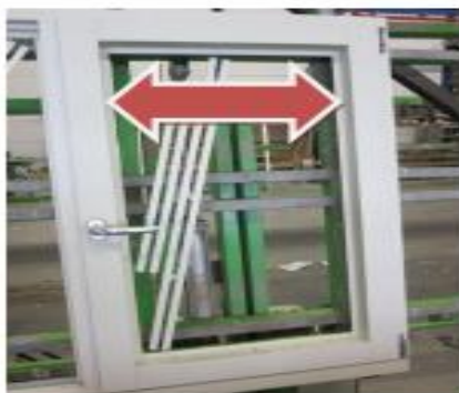
5. Raam verstellen in de breedte aan de bovenkant
