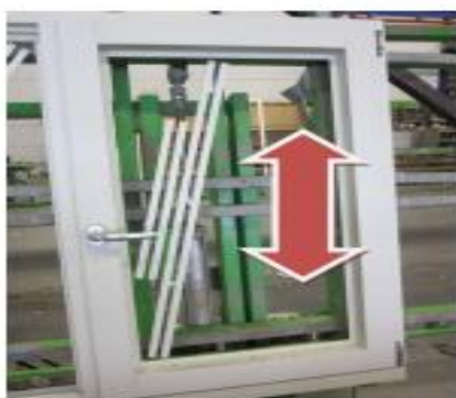
9. Raam verstellen in de hoogte aan de hangkant
