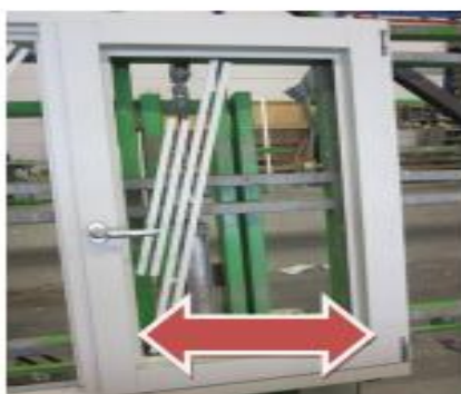
7. Raam verstellen in de breedte aan de onderkant
