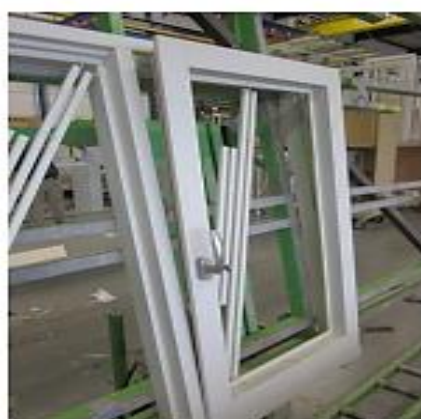
4. Draaikiepraam in kiepstand
